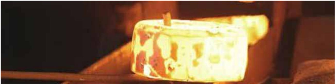
Включает в себя современный комплекс: две высокопроизводительные линии горизонтальной ковки усилием 800 и 1500 кН, а так же отжиговый агрегат.
